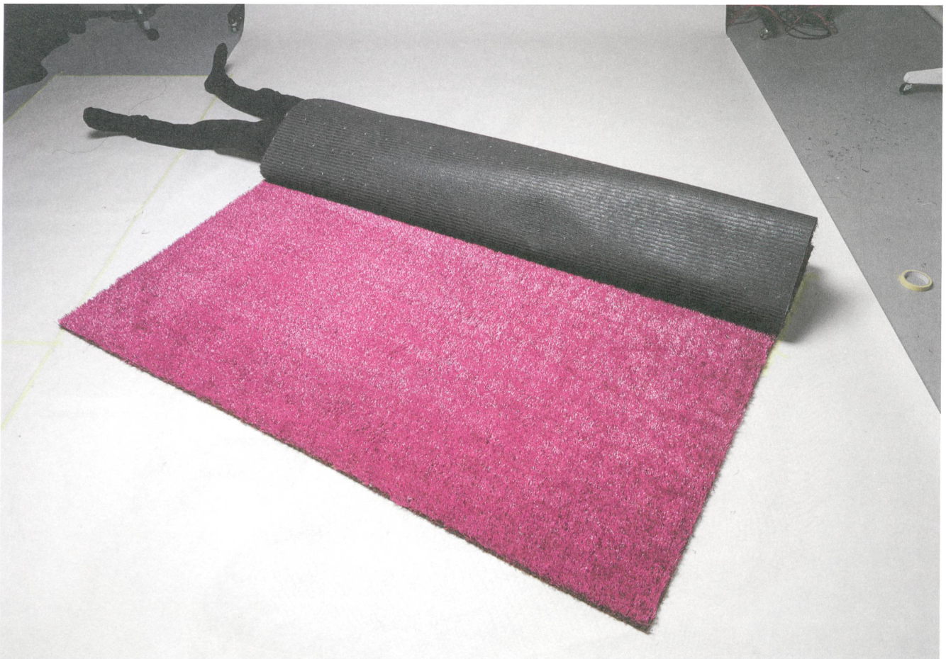
Der Kunstrasen bekommt seine Farbtiefe, indem er aus zwei unterschiedlich hohen, verschiedenfarbigen Floren getuftet wird.
