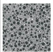
Mit Liapor Blähtonkügelchen als Zuschlagsstoff können Betone mit unterschiedlichem spezifischem Gewicht und verschiedenen Festigkeitsklassen gemischt werden. Beispielsweise Isolations-Beton, Leichtbeton, Super-Leichtbeton oder Extrem-Leichtbeton.
