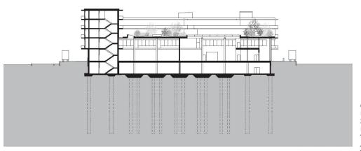
Längsschnitt: Gewerbehallen, Bürohaus mit Erschliessungsturm und Dachgarten – das ist Nœrd.
