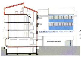
Querschnitt durch den Strassenbau mit dem neuen Dachgeschoss.
