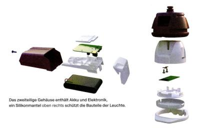
→ So hat Flink ein zweiteiliges, stossfestes Gehäuse aus Polypropylen gestaltet, an der Front zwei USB-Buchsen und ein Taster. Die Produktion kostet vier Dollar, Werkzeugkosten exklusive. Flink arbeitet mit Cap-Sense-Technologie, wie sie bei Berührbildschirmen verwendet wird: «So vermeiden wir einen mechanischen Schalter, der entweder teuer ist oder eine begrenzte Lebensdauer hat. Und die Benutzer bekommen ein Produkt, das ein Fünkchen Magie versprüht», sagt Remo Frei.
