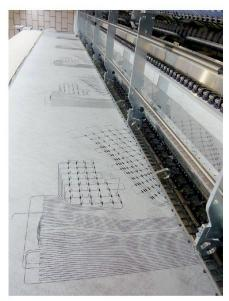
Versuch in der Produktionshalle von Forster Rohner: Die Stickmaschine bringt Sensoren auf Textilien.
