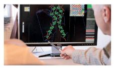
Stickdesign zu entwerfen, ist komplex, denn die Zeichnung muss für die Maschine umgewandelt und der Faden so geführt werden, dass innerhalb eines Musters kein Hohlraum entsteht.
