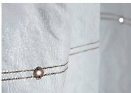
Wie glitzernde Pailletten sind die LEDs aufs Gewebe gestickt. Die zwei Leiterbahnen ergeben eine Doppellinie.
