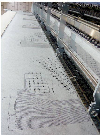
Versuch in der Produktionshalle von Forster Rohner: Die Stickmaschine bringt Sensoren auf Textilien.
