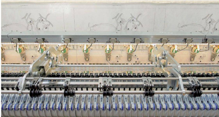
Stickmaschinen arbeiten mit bis zu 550 Nadeln. Wird das Ornament gestickt, steuert ein Computer die programmierten Koordinaten und bewegt den Stoff in die bestimmten Richtungen.
