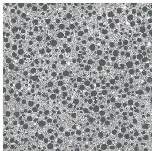
Durch Zugabe von Liapor-Blähtonkügelchen können zudem Betone mit unterschiedlichem spezifischem Gewicht und verschiedenen Festigkeitsklassen gemischt werden. Beispielsweise Konstruktions-Leichtbeton, Super-Leichtbeton oder Extrem-Leichtbeton.
