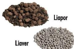
Liapor-Blähton und Liaver-Blähglas sind die idealen Zuschlagsstoffe, um aus gewöhnlichem Beton Isolations-Beton zu machen. Je nach Mischverhältnis mit unterschiedlichen Dämm-Eigenschaften.
