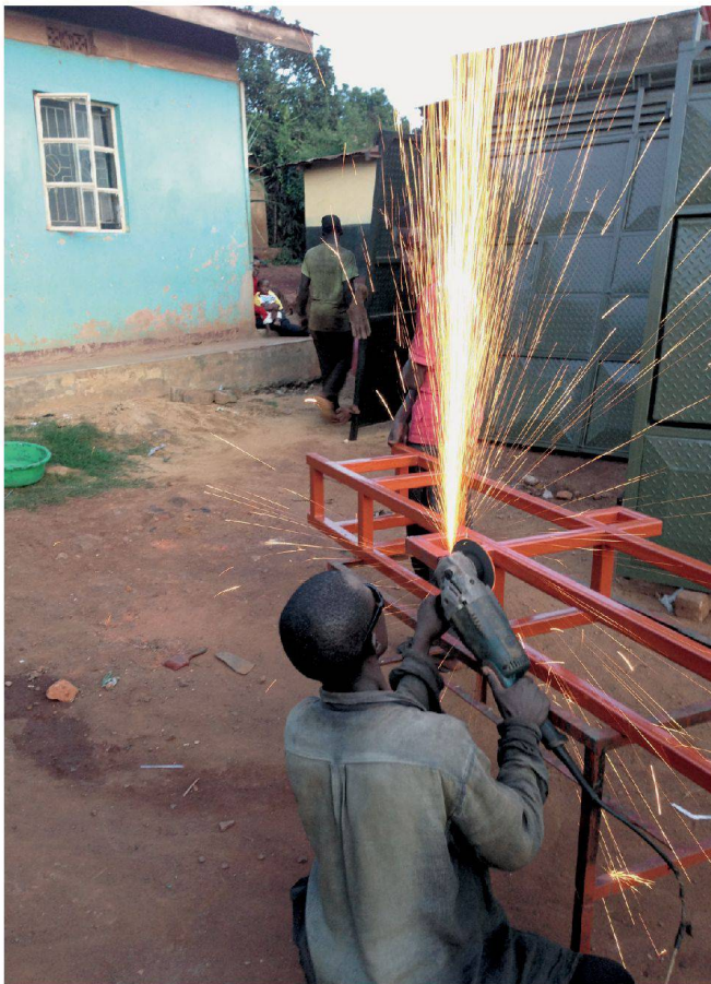
Produktion im Freien: Ein Handwerker bearbeitet mit einer Trennscheibe eine Stahlstruktur, wie sie für die Toilette gebraucht wird.
