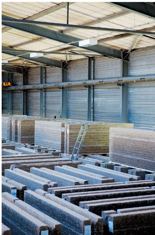
In der Halle bei Laufen trocknen die vorgefertigten Wände aus Stampflehm mindestens eine Woche. Dann werden sie auf die Baustelle transportiert.
