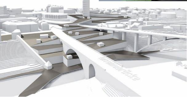
^B\_Pavillons mit Liftzugängen sorgen für die Erschliessung des Hangs.
