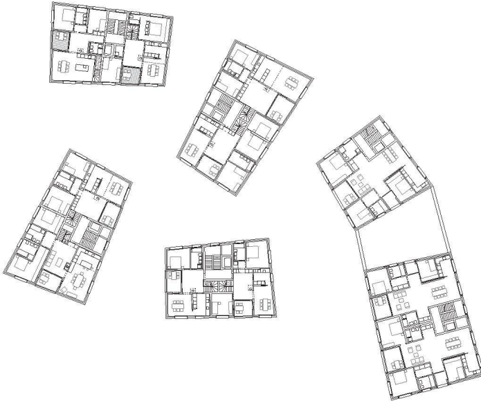
<Grundriss 2. Obergeschoss mit Wohnungen. Es gibt zwei Haupttypen: mit durchreichendem Raum oder mit Diele.
