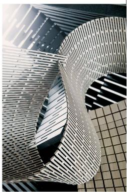
^Dank Schlitzen wird die Holzplatte mit «dukta» biegsam.
