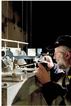
✓Ero Clalüna kontrolliert, ob sich die Staumauer bewegt. ✓Ero Clalüna tiene i movimenti della diga sotto controllo.
