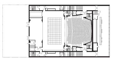
^Grundriss 3.0bergeschoss: Unter dem hinteren Teil des Saals erstreckt sich das Foyer mit Bar.
