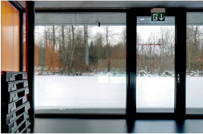
^Vogelschutzscheiben eingesetzt: Sporthalle am Waldrand in Sursee.
