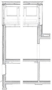
^Detailschnitt durch die Laterne: Die Erfindung ist, dass sie fassadenbündig ist.
