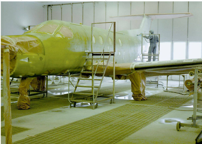
▼ Das fertig montierte «Airframe» einer «PC-12» bekommt in der werkeigenen Halle von Pilatus seine Grundlackierung.
