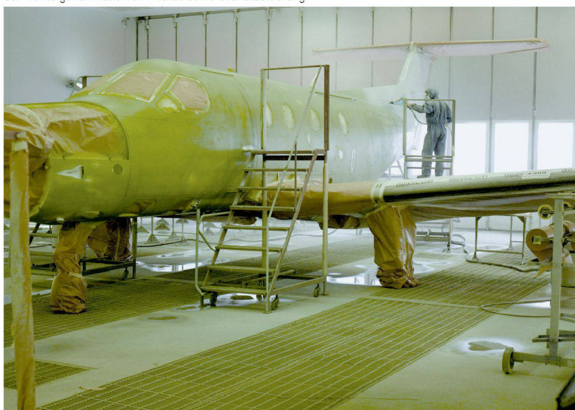
✓ Das fertig montierte «Airframe» einer «PC-12» bekommt in der werkzeigene Halle von Pilatus seine Grundlackierung.
