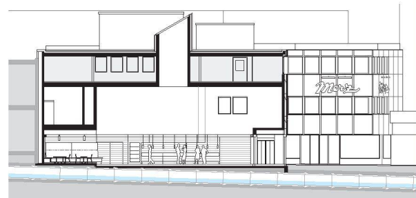
^Das Oblicht erweitert den Raum und spendet Tageslicht im über 20 Meter tiefen, nur einseitig befensterten Baukörper.
