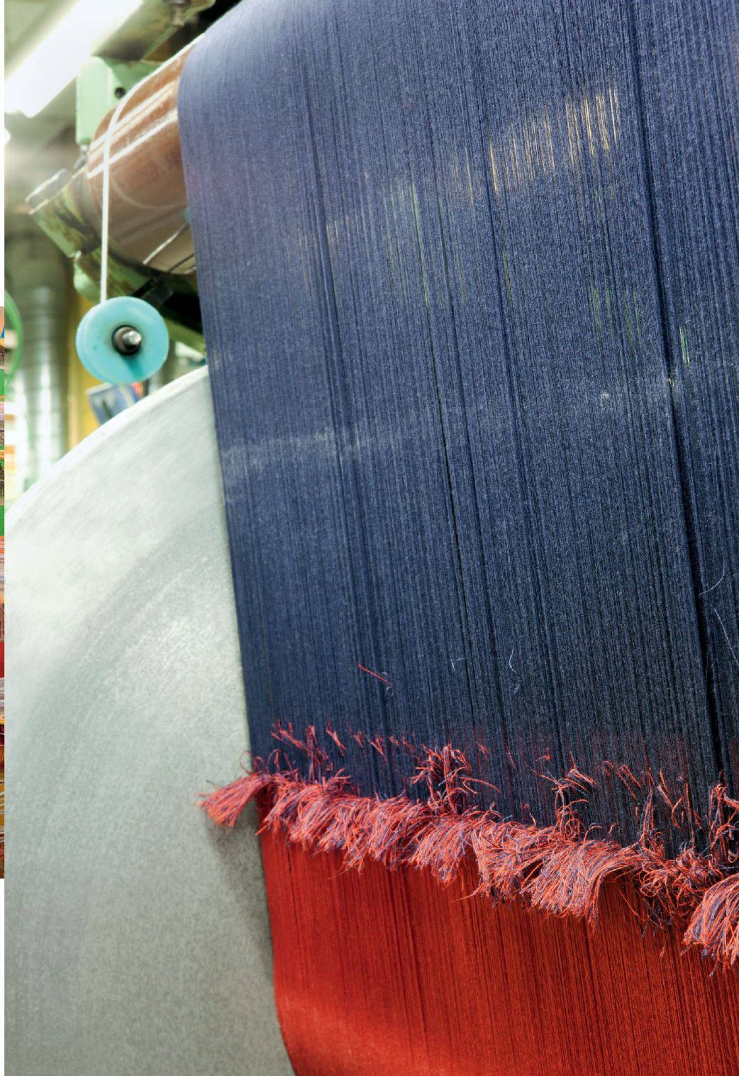
✓ Auf der Musterkette wird das Material durch Anknöpfen gewechselt.
