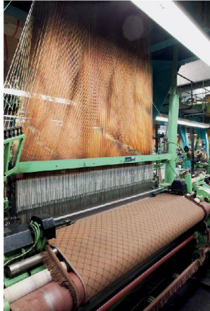
✓ Ein Möbelstoff auf einer Jacquardmaschine in Bühler bei Tisca Tiara.
