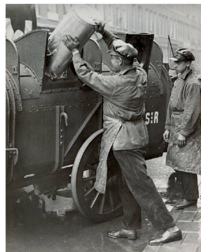
^Der Kehrichtmann hakte den Klappdeckel des ursprünglichen Ochsner-Kübels beim Wagen ein, damit sich dieser automatisch öffnete und entleerte.
