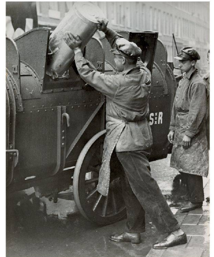
^Der Kehrtrichmann hakte den Klappdeckel des ursprünglichen Ochsner-Kübels beim Wagen ein, damit sich dieser automatisch öffnete und entleerte.
