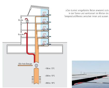
^2\_Wärme bereitstellen: «B35» nimmt über die Erdsonde Wärme auf, die Wärmepumpe heizt damit das Warmwasser auf maximal 42 Grad.
