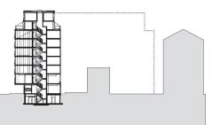
^Querschnitt mit der Auskragung über dem Erdgeschoss.
