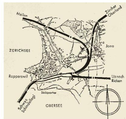
«Haefeli, Moser, Steiger wollten schon 1943 mit dem Projekt «Schleife» die Verkehrsprobleme lösen: die Bahn verlegen und das Schienentrassée als neue Strasse nutzen.
