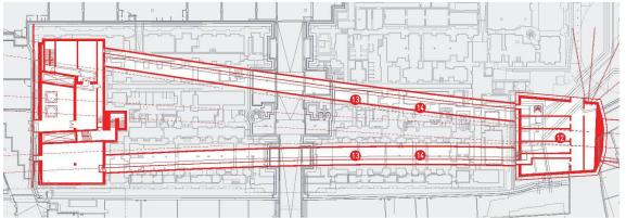
^Grundriss der beiden Längsstollen direkt unter dem alten Bahnhofgebäude; Ouerstollen und Deckenplatte sind noch nicht erstellt.
