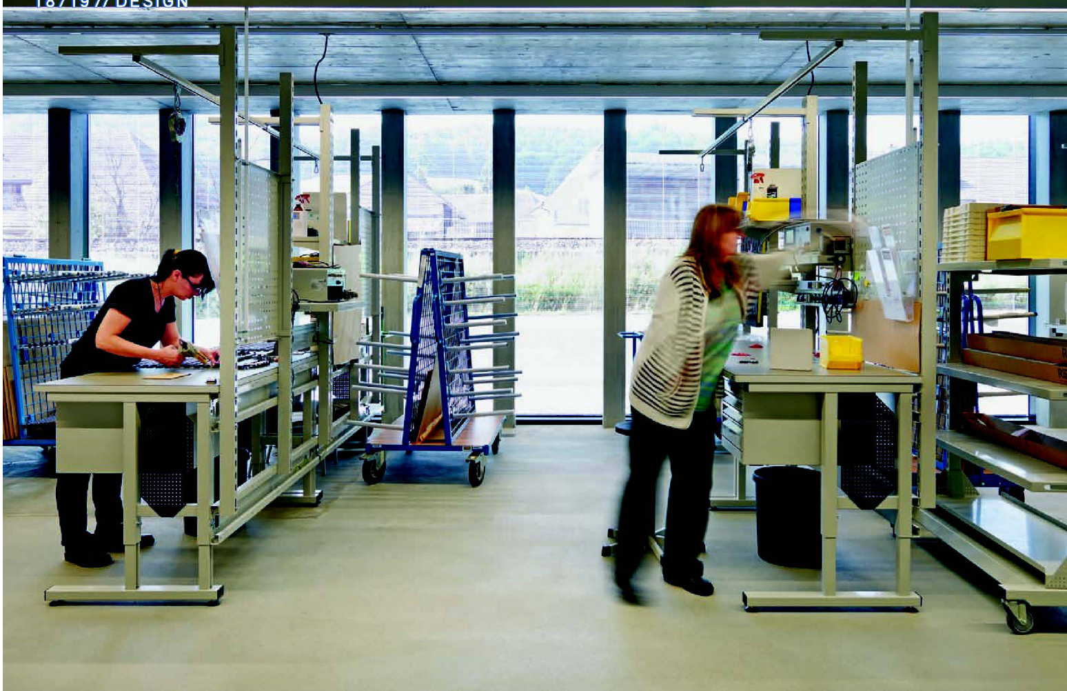
^In der Montagehalle: Zwölf Mitarbeiterinnen und Mitarbeiter setzen da die Teile, die die Lieferanten im Auftrag der Firma gebaut haben, zu Leuchten zusammen.
