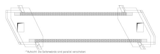
^Die 64 Millimeter starken Steinplatten umschliessen die leicht konischen Betonpfeiler.
