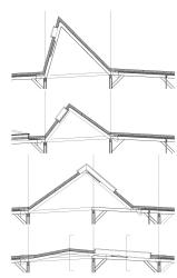
^Vertikalschnitte der Dachkonstruktion.
