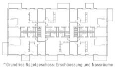
Grundriss Regelgeschoss: Erschliessung und Nassraun sind betoniert, andere Raumteilungen im Leichtbau.
