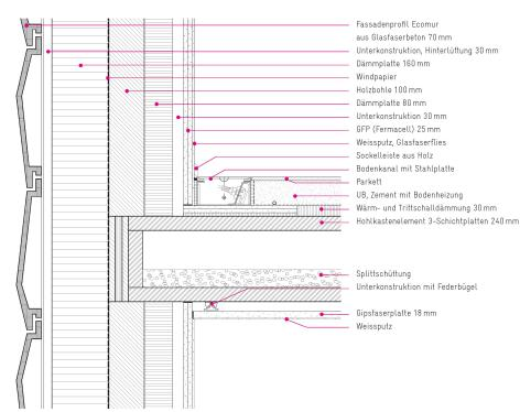
^Detail Deckenanschluss-Fassade 1:10
