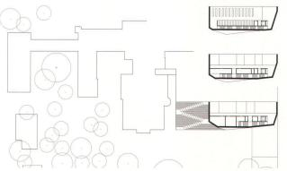
^Obergeschosse: Eine Kaskadentreppe erschliesst die einbündige Anlage der Büros.
