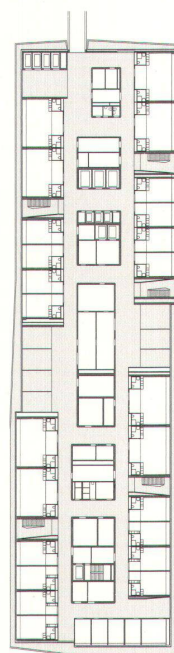
^Normalgeschoss des Bettenhauses Triemli: Die öffentlich zugänglichen Treppenhäuser sind nicht mehr im Kern.
