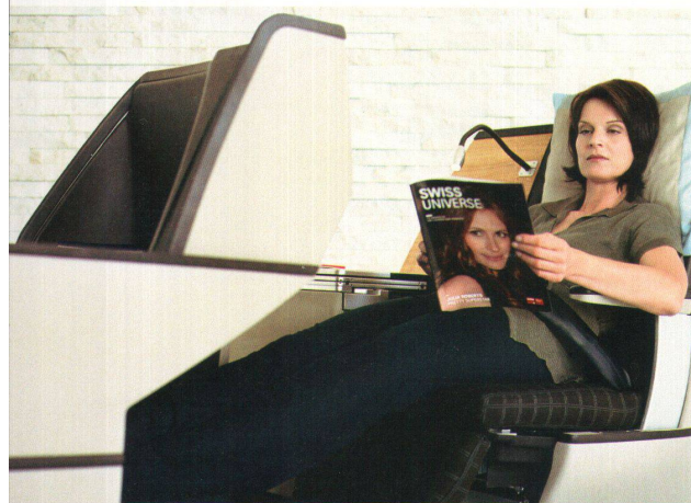
<So vergeht die Zeit im Flug: Im Business-Class-Sitz aus glasfaserverstärktem Kunststoff lassen sich Unterhaltungsinstrumente und Ablageflächen verbergen.
