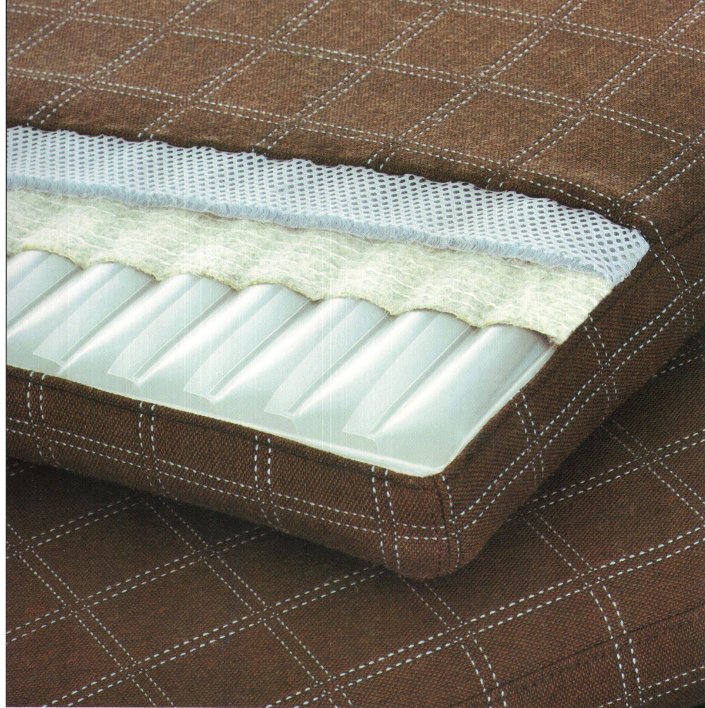
^So fliegen alle leichter: Im Kern die Luftkammern, darüber ein Kevlargetze, dann ein 3D-Gewebe für die Klimatisierung und schliesslich das Deckmaterial.
