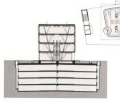
^Der Schnitt zeigt die spezielle Tragstruktur von «La Miroiterie»: Das Haus steht auf der Mittelstütze des unterirdischen Parkings.
