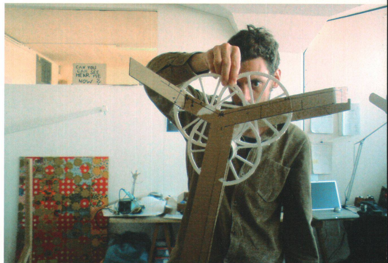
^Das Spiel der Zahnräder wird im Modell getestet. Zwei Zustände müssen gestalterisch kontrolliert werden: wenn die Räder stehen und wenn sie drehen.
