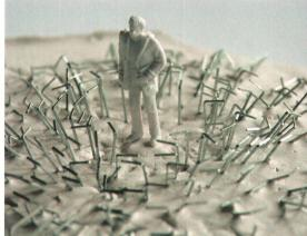
∨Proben mit Metallspänen in flüssigem Harz, die Magnete seitlich
