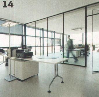
Elementen bis zu 321 auf 600 Zentimetern erhältlich. Die rahmenlose Konstruktion vermeidet Schallbrücken weitgehend. Wand-, Boden- und Deckenanschlüsse sind in das Bauteil eingelassen. [www.glastroesch.ch](http://www.glastroesch.ch)
