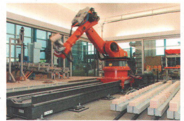
Maurerroboter an der «Swissbau»
