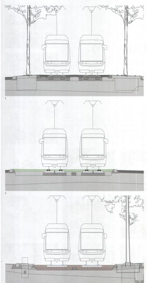
Schienen mit einem Schotterrasensubstrat eingedeckt. Kammerfüllkörper schützen die Schienenbefestigungen und halten den Schienenkopf vom Kiesmaterial frei.
