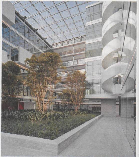
2 Glaslamellen ziehen sich ums ganze Haus. Sie bewegen sich mit dem Lauf der Sonne und schützen das Haus vor zu viel Hitze.
