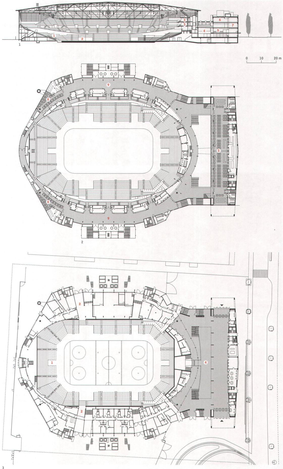
**1 Im Schnitt gibt die Horizontale auf der Höhe der Dachkante an, wo früher die Zwischendecke lag. Nur die untere Hälfte der 10 Meter hohen Träger war zu sehen. Heute ist der Blick in die Dachkonstruktion frei.**
