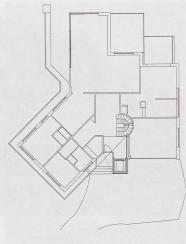
1 Dem Gefüge des Grundrisses gemäss ist der Liftanbau als eigenständiger Körper zwischen zwei Hausteile gestellt.
