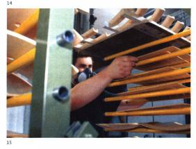
pneumatischen Zwingen befestigt. Der Arbeiter dreht die Spannvorrichtungen, bis er an jedem Stück die verschiedenen Arbeitsgänge erledigt hat. Während der Leim an einem Stück abbindet, kann er sich schon dem nächsten widmen. Und später am ersten Stück fortfahren.
