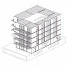
Schrittweise Darstellung der Montage der Rahmenbauwände und Brettstapeldecken rund um den Betonkern.
