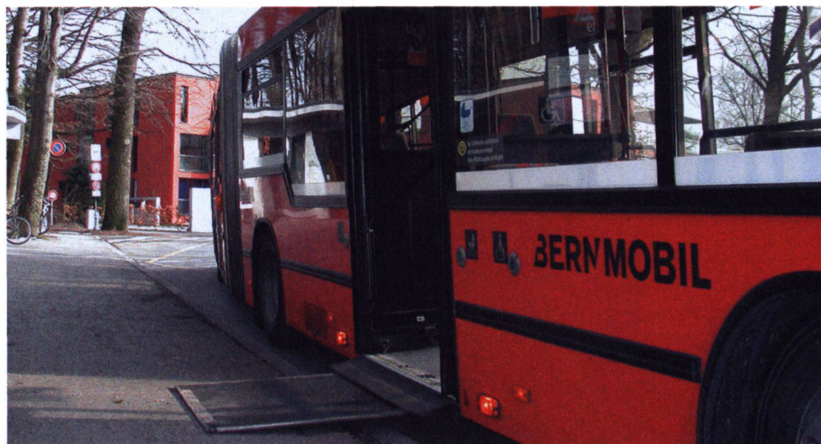
1 Berner Busse und Trams haben teils ausfahrbare Rampen eingebaut. In den übrigen Fahrzeugen gibts mobile Rampen.
