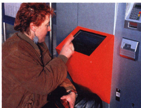
6 SBB-Billettautomat: Vorbildlich gelöst für die Rollstuhlfahrerin, aber mit Touchscreen unbrauchbar für Blinde.
