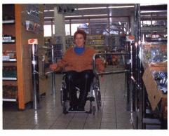
24 Coop ist bereits so weit: Die Eingangsschleuse ist optisch gesteuert und öffnet sich automatisch.
