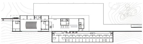
Grundriss des Erdgeschosses. Hinter der Mauer der Hoteltrakt, davor die Halle und links der Eingang. Links der Saal mit vier Seminarräumen.
