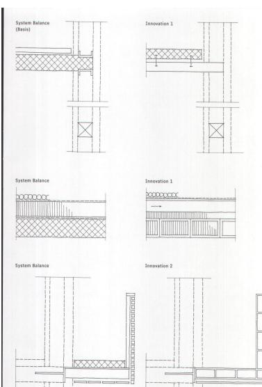
Ersatz der Zwischengeschossdecken aus Beton inkl. Unterlagsboden, 25 cm, durch zweischalige Konstruktion derselben Dicke aus verleimter Holzplattendecke und darüberliegender, mit Spezialdübeln statisch verbundenen, leicht armierten Betonplatte.
