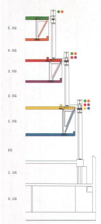
Das Schema illustriert den Kräfteverlauf an der stadtseitigen Fassade. Im untersten Auflagerpunkt konzentrieren sich die Lasten aller darüber liegenden Geschosse.
