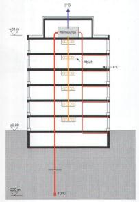
Funktionsschema der Heizung mit Erdsonden
