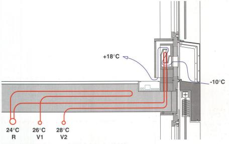
Fassadenschnitt durch die Brüstung mit LUBO, Bodenkanal und Heizleitungen
