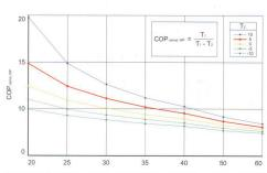
Der Verlauf des theoretischen Wirkungsgrades einer Wärmepumpe
