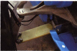
Oben: Unverwundlich und leicht: Der vordere Querträger aus Epoxi ist zugleich Blattfeder
